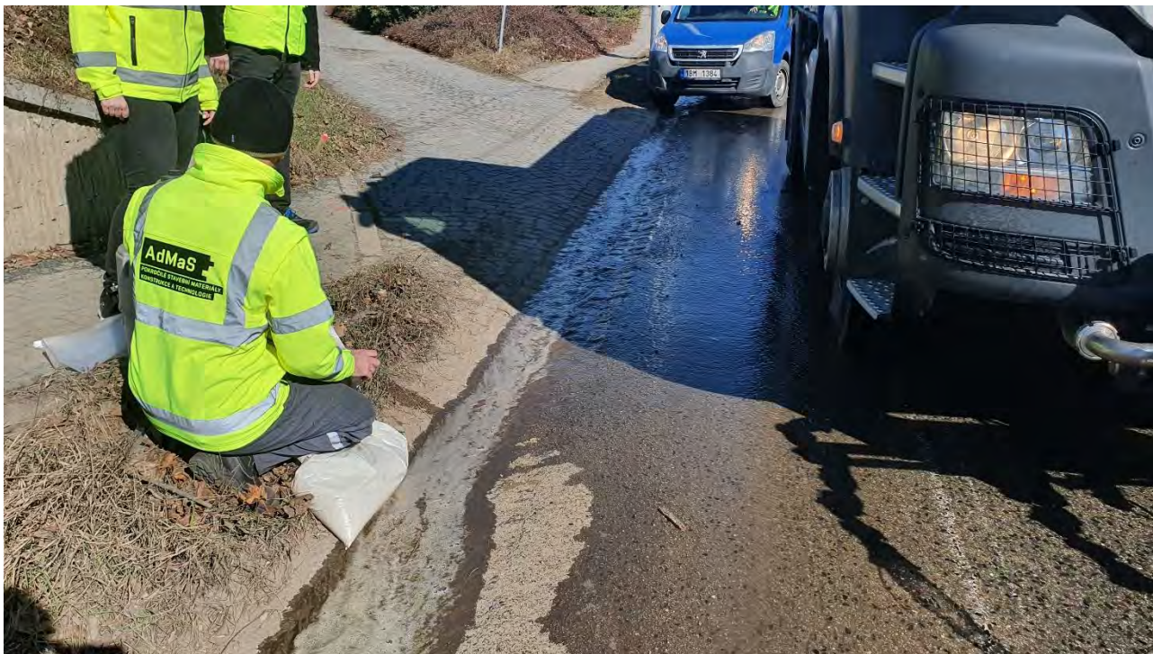
Obr. 19 Povrchový odtok ze silnice na ul. Rokytova po umělém kropení
