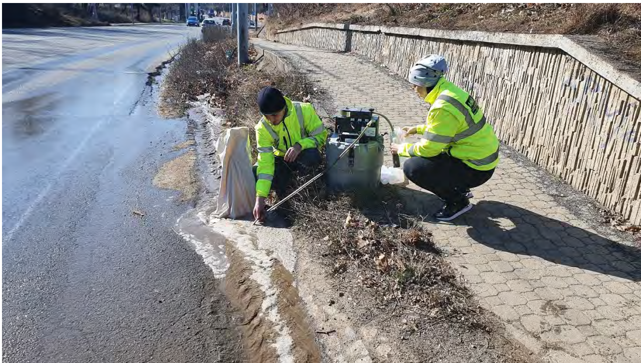
Obr. 20 Obr. 21 Vzorkování povrchového odtoku ze silnice na ul. Rokytova (ROK-C) po umělém kropení
