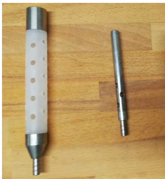
Obr. 27 Standardní sací koše ISCO použité při monitoringu
