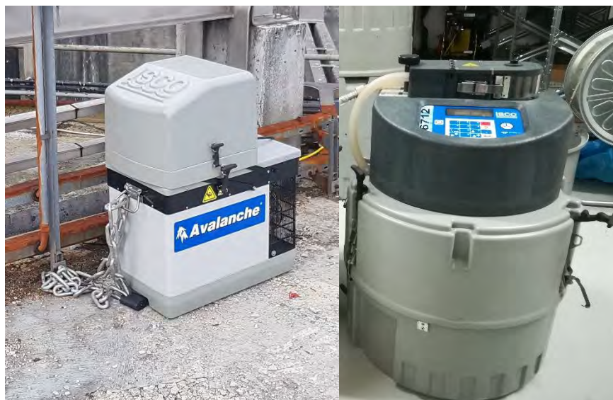
Obr. 26 Vzorkovače ISCO 6712 Avalanche a ISCO 6712 compact
